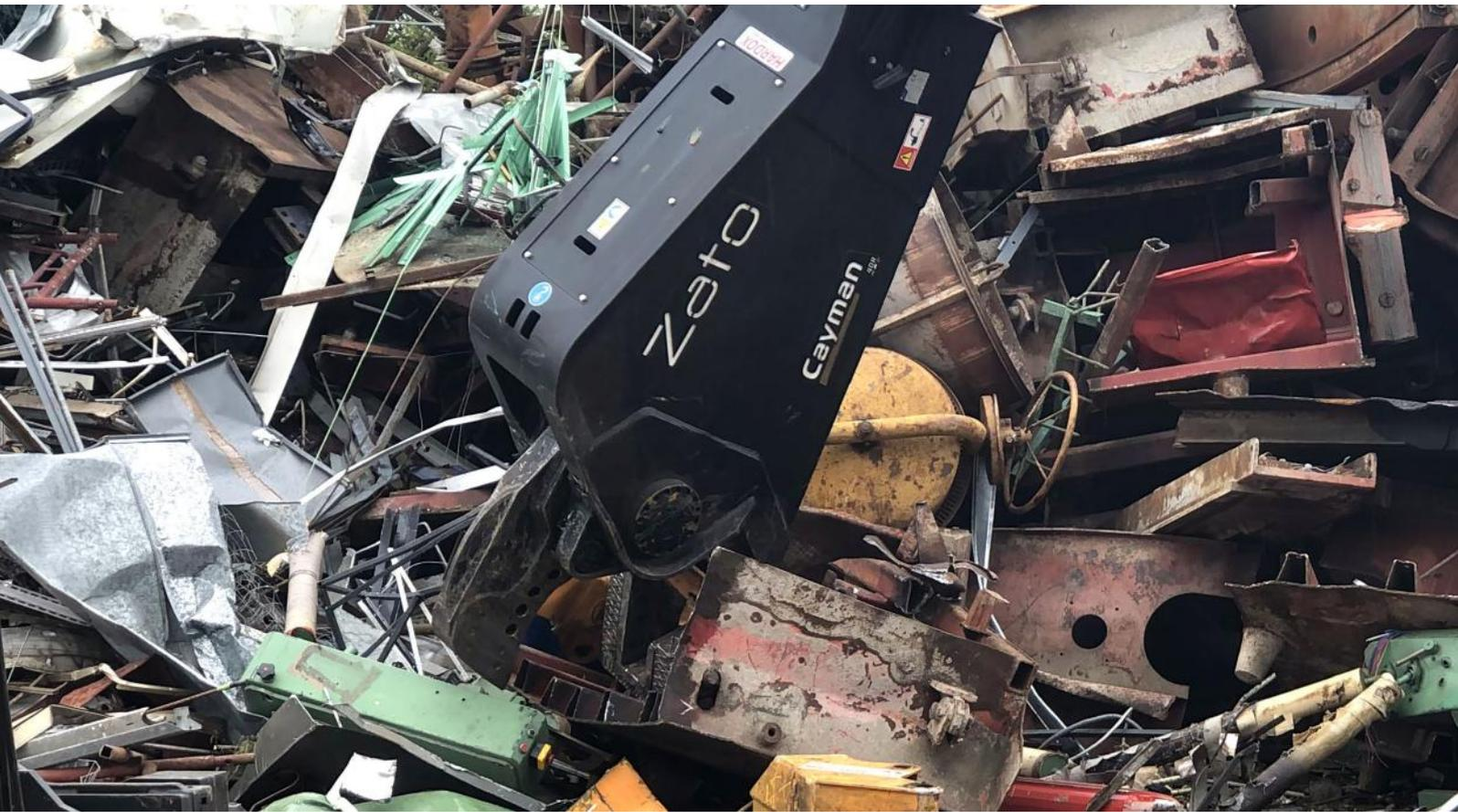
Hydraulische Scheren sind ein wichtiges Werkzeug für den Abbruch-, Verschrottungs- und Recyclingsektor.
